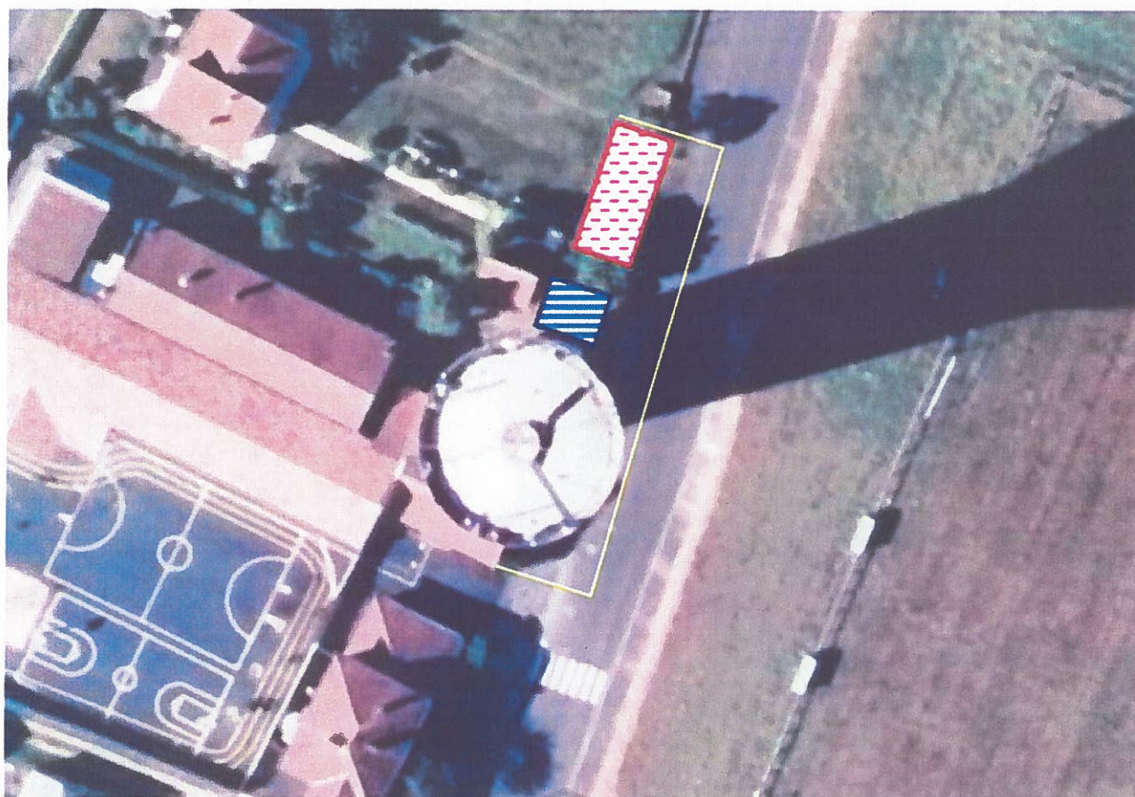
Plan d'installation de chantier
